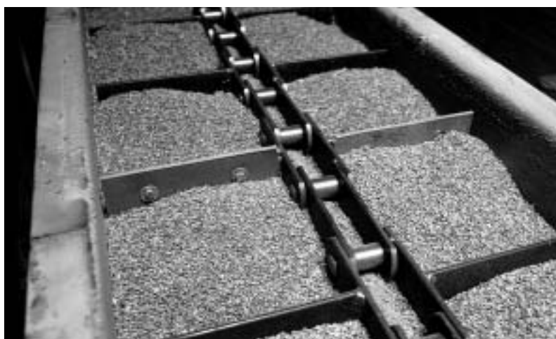
Förderketten nach DIN 8165 / FV-Serie Conveyor Chains DIN 8165 / FV-Series Cadenas de transporte DIN 8165 / Serie FV
