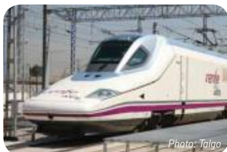
Испанский высокоскоростной поезд Talgo 350, макс. скорость 350 км/ч, тяговый дв. пр-ва Siemens, мощность 8 x 1 000 кВт, в эксплуатации с 2005.
