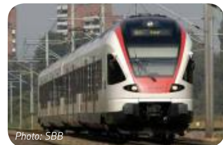
SBB FLIRT RABe 521/ 523, Швейцарские железные дороги, макс. скорость 160 км/ч, тяговый дв. пр-ва TSA Traktionssysteme, мощность 4 x 500 кВт, в эксплуатации с 2004.
