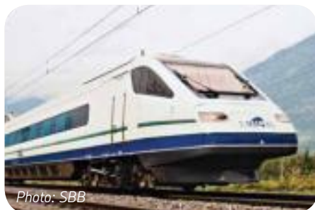
Pendolino ETR 460, Италия, поколение поездов с принудительным наклоном кузова, макс. скорость 250 км/ч, тяговый электродвигатель пр-ва Alstom, полная мощность 6000 кВт, в эксплуатации с 1992.
