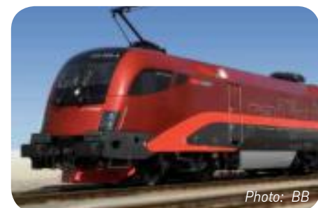
Австрийский электровоз BB Taurus 1016/1116, тах. скорость 230 км/ч, тяговый дв. пр-ва Siemens, мощность 4 x 1600 кВт, в эксплуатации с 2000.
