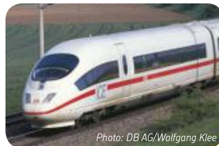
Немецкий высокоскоростной поезд DB ICE 3, макс. скорость 330 км/ч, тяговый дв. пр-ва Siemens, мощность 16 x 500 кВт, в эксплуатации с 1999.
