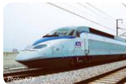
Корейский высокоскоростной поезд KTX, скорость 300 км/ч, тяговый дв. пр-ва Rotem, мощность 12 x 1130 кВт, в эксплуатации с 2004.
